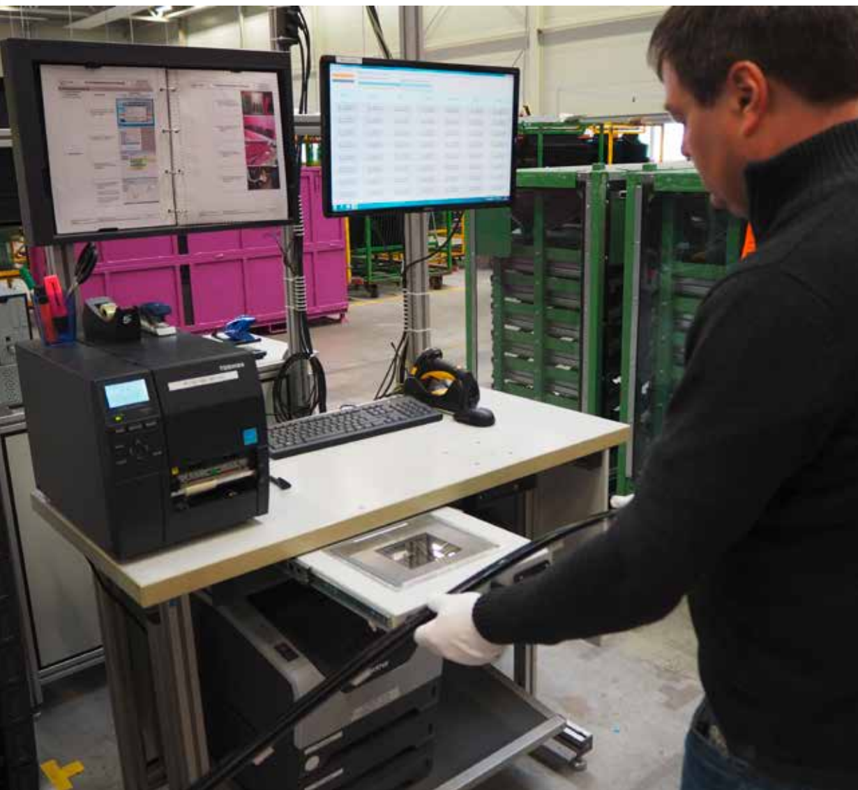
Der Einsatz eines eingebauten Scanners erleichtert die Arbeit mit unhandlichen Teilen in Magstadt
