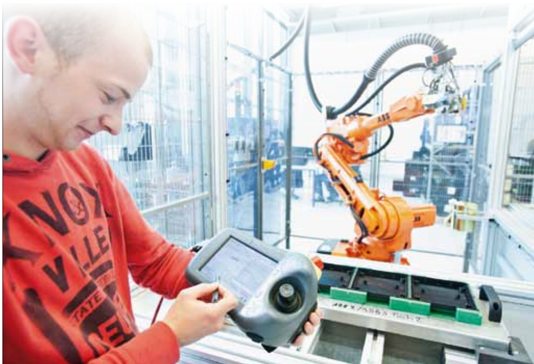
Beschäumen von Dichtungen mit 1K-Polyurethan-Elastomer im Werk Calw.
